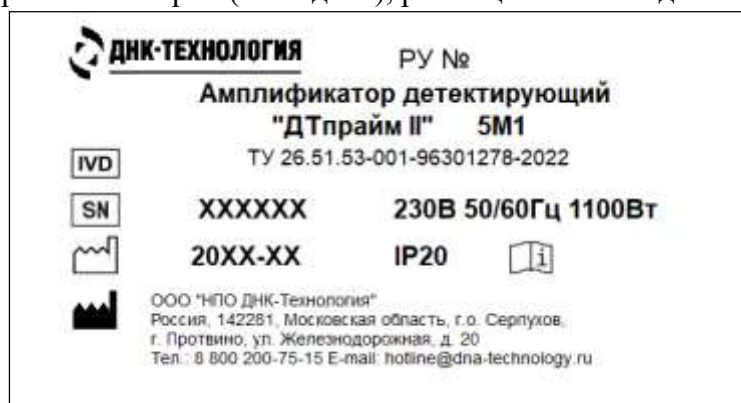
Рисунок 2.2 – «ДТпрайм II», шильдик
