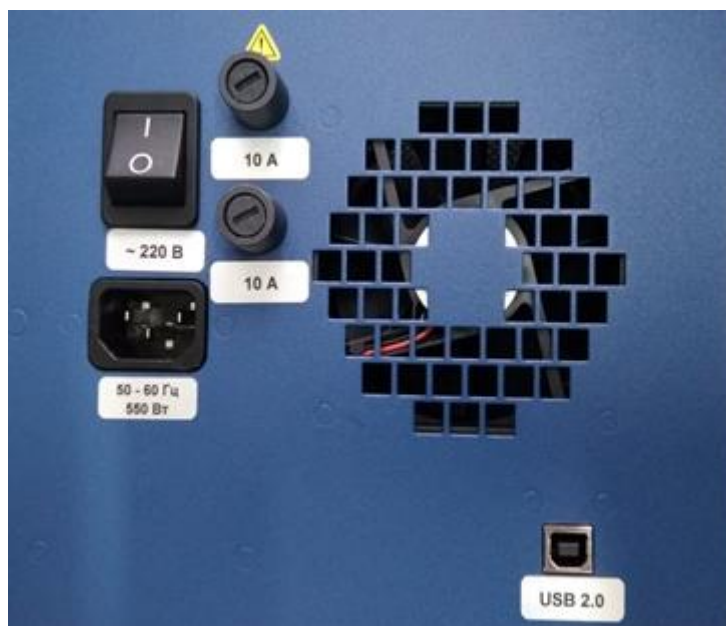
Рис.3. Расположение разъемов на задней панели прибора
