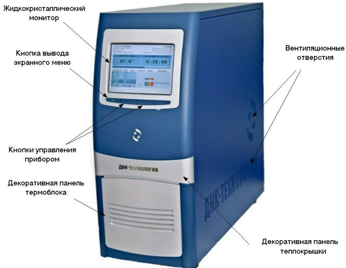
Рис.2. Расположение элементов управления и индикации
