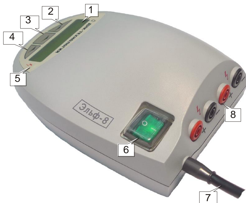
Рис.1 Индикация состояния источника осуществляется с помощью графического жидкокристаллического индикатора(1) и светодиода(5), а управление – трёх кнопок (2,3 и 4) (рис. 1). Сетевой выключатель (6) расположен на верхней крышке. (7) — сетевой шнур, (8) — выходные клеммы. Две пары выходных гнезд прибора соединены параллельно. Таким образом, при подключении двух нагрузок (ванн для электрофореза) будет контролироваться их суммарный ток и суммарная мощность.
