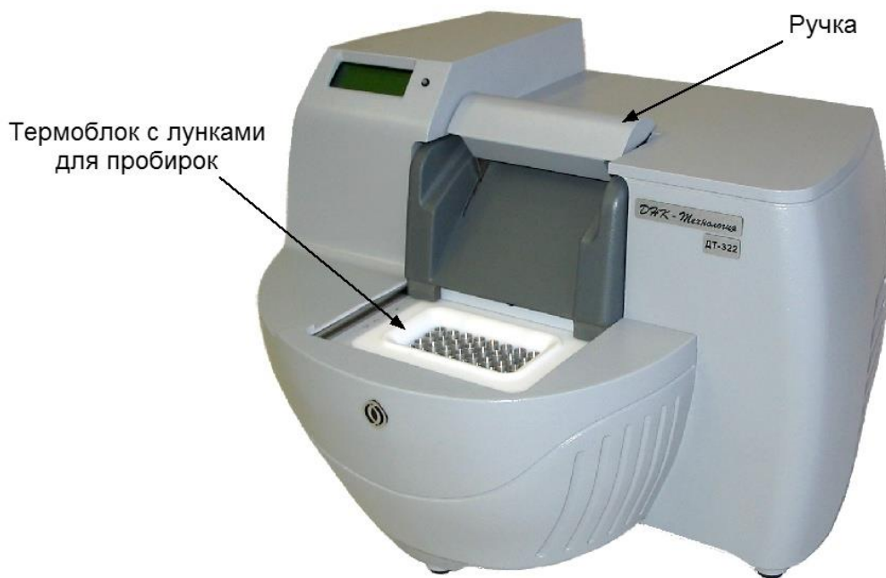
Рис.15. Внешний вид амплификатора ДТ-322 с открытой кареткой.
