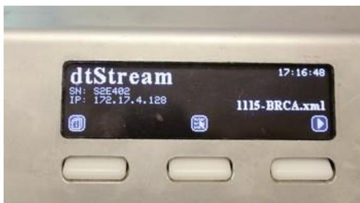
После выбора задания от ЛИС или сценария дозирования, необходимо повторно нажать правую кнопку устройства дозирующего. На дисплее появится сообщение «Идёт загрузка», затем начнётся процесс дозирования с отображением на дисплее хода выполнения сценария дозирования или задания.
