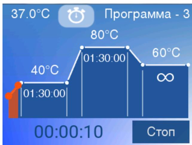
*Рис. 14 Пример окна запущенной пользовательской программы (3 температурных полки):*
