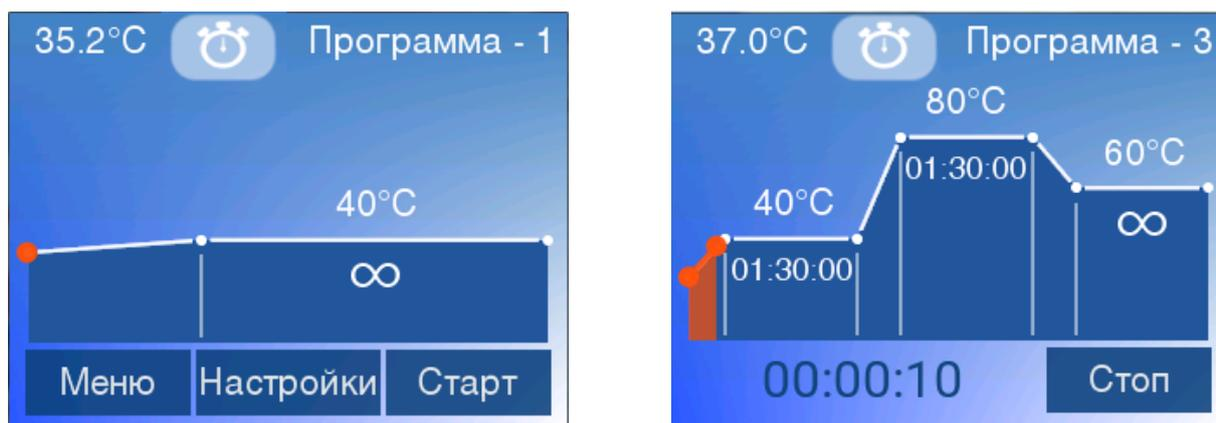
*Рис.8 Примеры окон пользовательской программы (1 и 3 температурных полки)*
