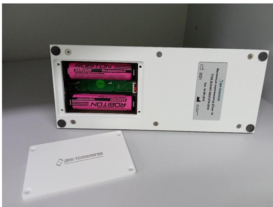
Рис.3 аккумуляторный отсек, вид прибора снизу
