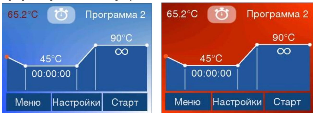
Рис. 9 Пример окна пользовательской программы при переходе в начало заданной программы (2 температурных полки, индикация перегрева матрицы).
