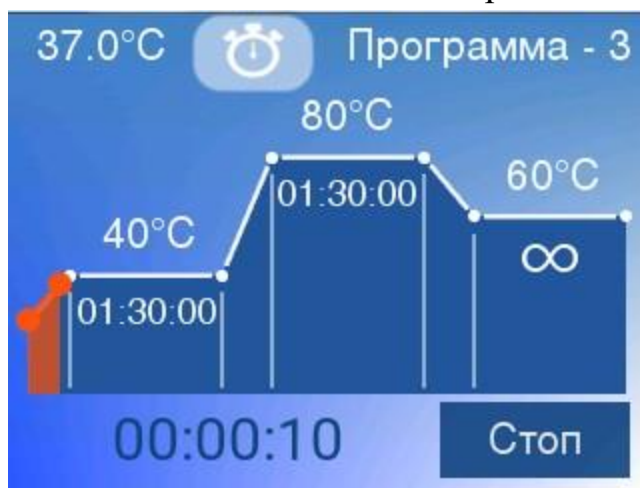
Рис. 14 Пример окна запущенной пользовательской программы (3 температурных полки):
